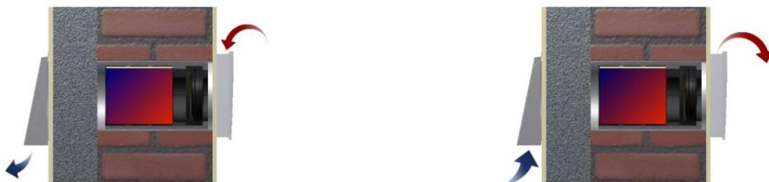
Prinzip der Wärmerückgewinnung
